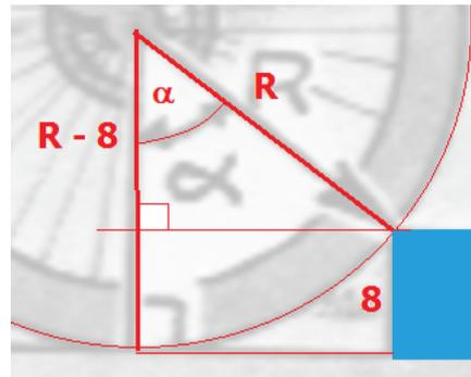
Bei einem größeren Reifendurchmesser wird der Winkel  $\alpha$  kleiner und somit auch die Kraft, die der Fahrer zur Überwindung des Hindernisses aufwenden muss.
